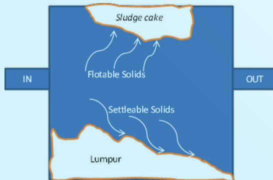
Gambar 6.10. Skema penampungan dan pengendapan Partikel Koloid
