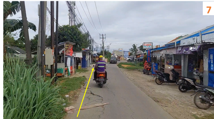
7 Rencana: Pemasangan pipa JDU diameter 200 mm, jalan rajeg mulya (area 4) (06°06'37"S 106°32'10"E) Metode: Boring manual Keterangan: Reduce diameter pipa
