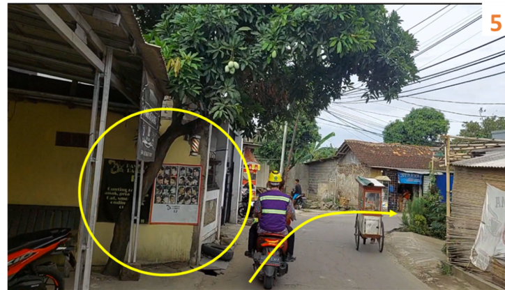
5 Rencana: Pemasangan pipa JDU diameter 355 mm, jalan rajeg mulya (area 4) (06°06'43"S 106°31'47"E) Metode: Boring manual Keterangan: Tembok bangunan menjorok hingga badan jalan. Pemasangan pipa dilakukan di luar tembok rumah
