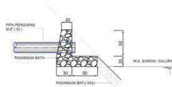
POTONGAN A - A PIPA PENGURAS DIBAWAH MUKA AIR
