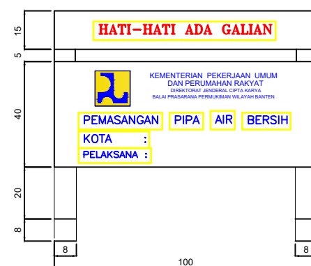
RAMBU - RAMBU JALAN SKALA 1 : 12,5
