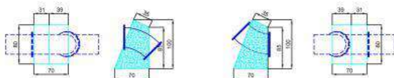
DENAH DAN POTONGAN THRUST BLOCK Skala : 1 : 50
