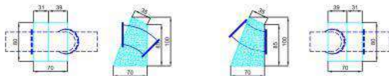
DENAH DAN POTONGAN THRUST BLOCK
